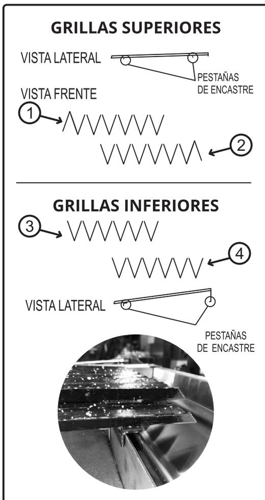
La grilla superior debe encastrar en la inferior, para ello posee una pequeña pestaña en su reverso. Las grillas deben posicionarse de manera que **NO** coincidan V superiores con las V inferiores.
